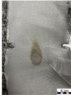
Abbildung 12: Brandmarke auf mit Flammschutzappretur veredeltem „KlevoGlass 550 V4A-1 L“ ohne Lochbildung
