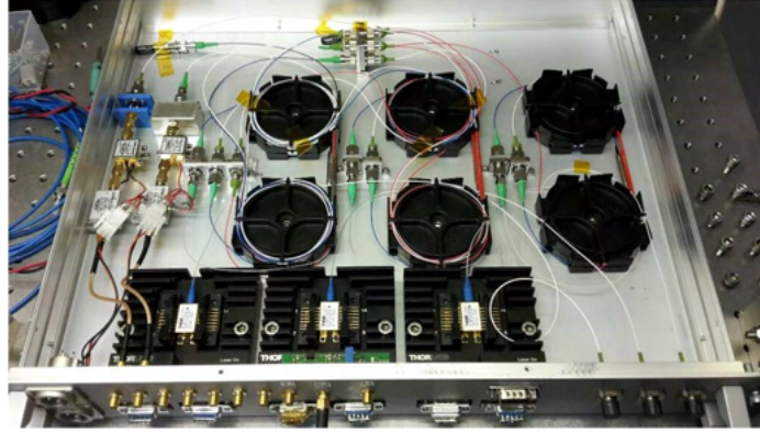
Abbildung 2.2: Frequenzverdoppelt, faserbasiertes Lasersystem basierend auf Telekom-Technologie zur Raman- und Bragg-Strahlteilung.
