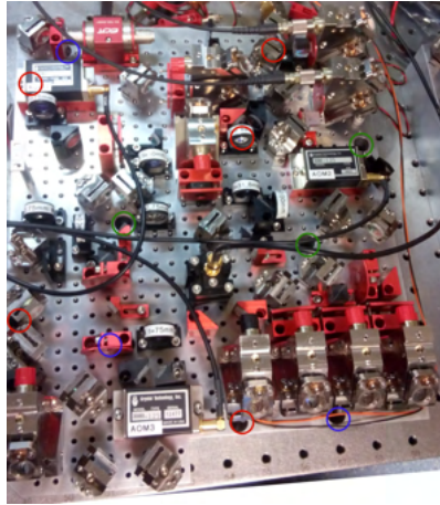
Abbildung 2.39: Das Kalium Lasersystem, bestehend aus einem Referenzlaser und drei MOPA Lasern welche für die Rückpumpung & die Interferometry, sowie die 2D und 3D Kühlung verwendet werden. Das System ist untergliedert in drei Module. Das MOPA Modul beinhaltet die eigentlichen Laser, von hier wird das Licht in das Verteiler & das Raman Modul geleitet. Im Raman Modul wird dabei das Licht für die Atom-Interferometrie-Pulse, im Verteilermodule das Licht für die BEC Generierung bereitgestellt. In beiden Modulen wird das Licht in die jeweiligen Fasern eingekoppelt, welche runter zur Experimentier-Kammer geführt und dort eingekoppelt werden.
