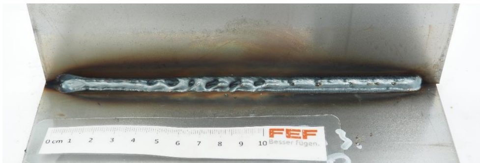
Abbildung 7: Eine Probe mit Fehlern erzeugt durch bewusstes Überschreiten des Prozessfensters.
