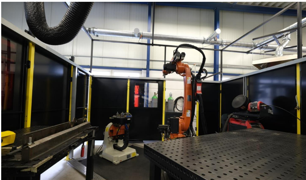
Abbildung 6: Versuchszelle für den Demonstrator
