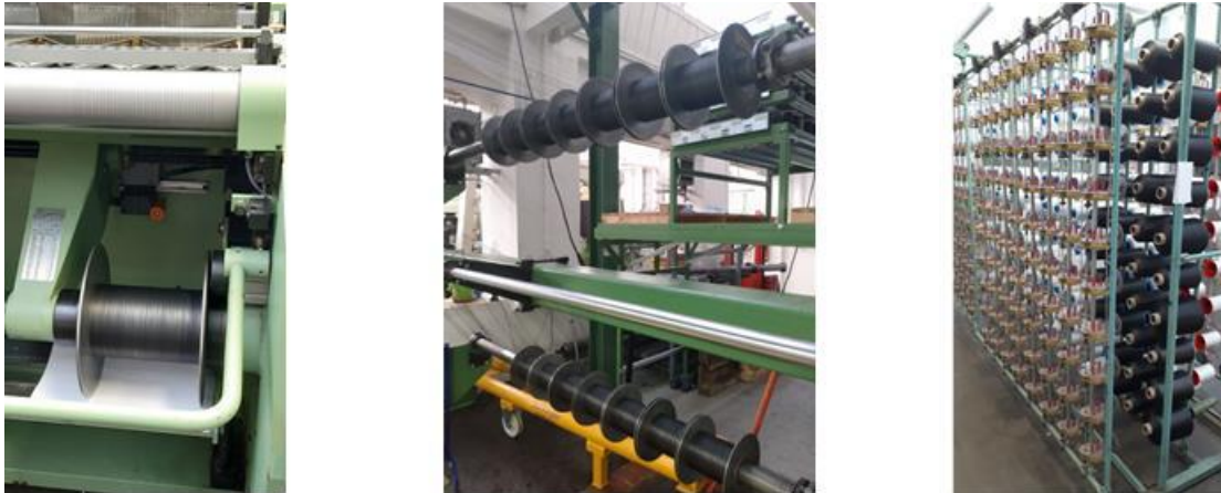
Abb. 14-16: Schärversuche mit dem kohlenstoffhaltigen hiTEX-Faden in AP 4
