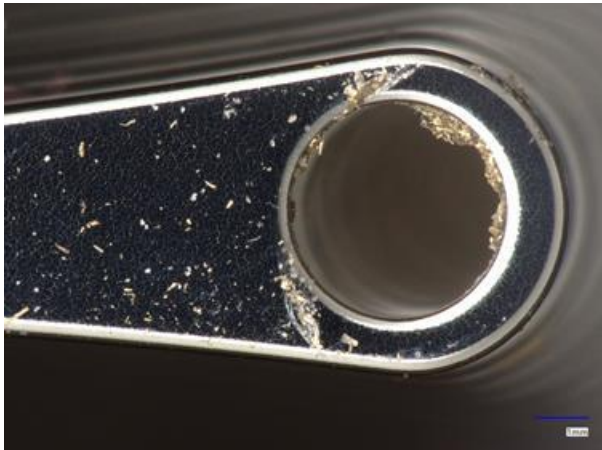
Abb. 38: Lochnadelblei 8 (Tuch) mit modifizierter Shieldex®-Variante M2 vor der Reinigung
