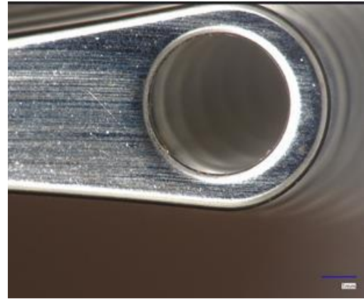
Abb. 20: unbeschichte Shieldex ® -Variante nach der Reinigung
