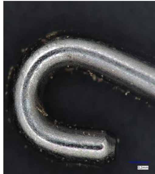
Abb. 35 und 36: Verschleiß an beschichteter Zungennadeln nach Versuchen am TENS-O-MAT II
