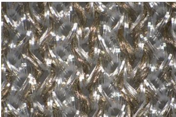
Abb. 40: Wirkversuch (Tuch) bei optimierter Beschichtungsaufgabe bei Shieldex®-Variante M2
