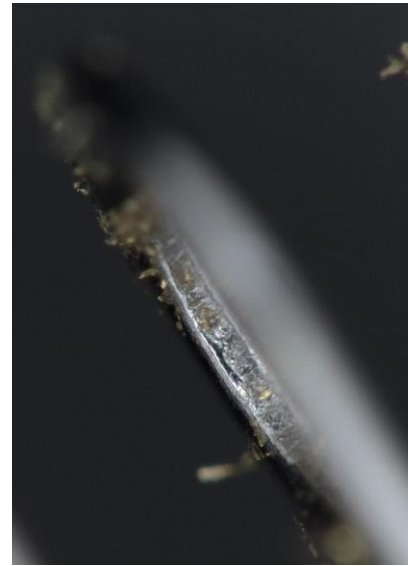
Abb. 33 und 34: Verschleiß an beschichteter Lochnadel nach Versuchen am TENS-O-MAT II
