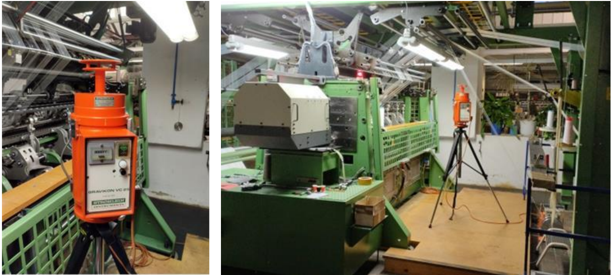
Abb. 21 und 22: Versuchsbegleitende Staubmessungen zu AP 4
