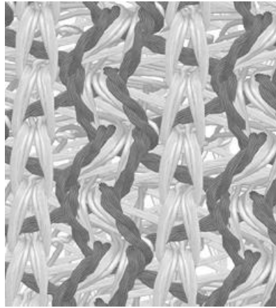
Abb. 6: Layout Tuch geschlossen (Warpsimulation)
