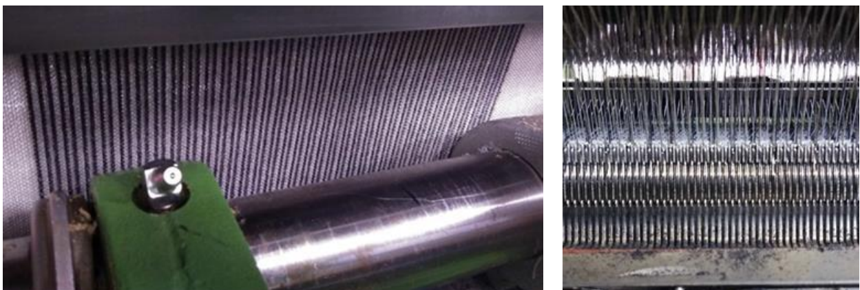
Abb. 17-18: Abriebserscheinungen bei den Wirkversuchen auf der Doppelraschelmachine RD 7 DPLM 12-3
