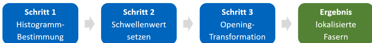
Abbildung 4: Vorgehen zur Lokalisierung der Nanofasern im Bild
