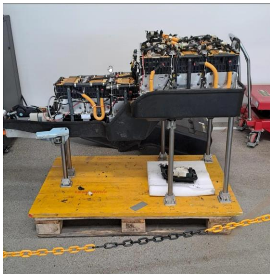
Abbildung 14: Ausgebaute Antriebsbatterie des E-Coupes.
