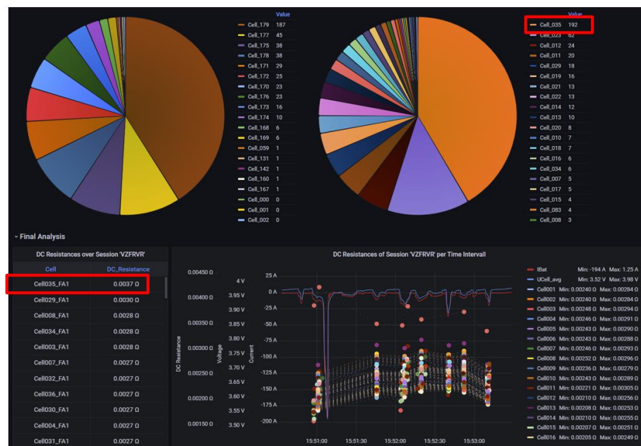
Abbildung 13: Berechnung der Zellwiderstände des E-Coupes.
