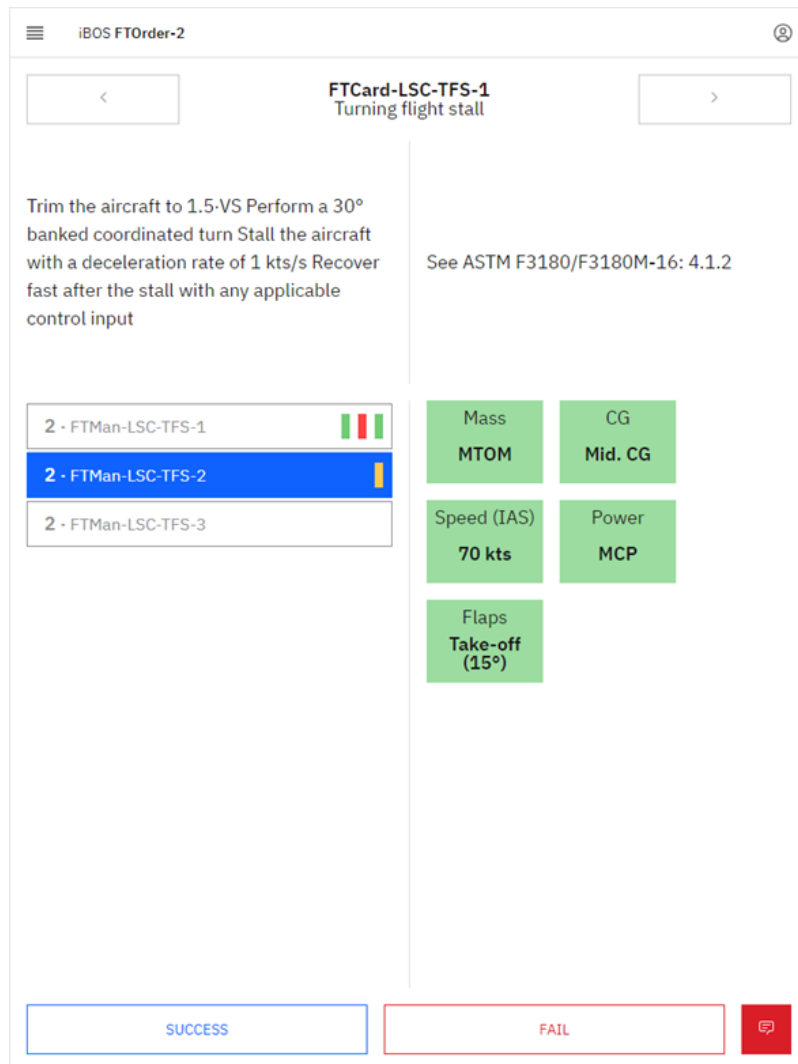
Abbildung 2.6: Pilot's View der Flight-Test-Seite während eines aktiven Manövers. Mittels der "SUCCESS" und "FAIL" Knöpfe kann die Beendigung des Manövers signalisiert werden. Die rote Nachrichtenbox signalisiert, dass eine ungelesene Nachricht auf Bestätigung wartet.
