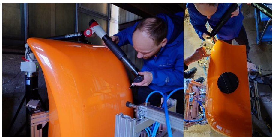
Abbildung 19: Vermessung der Verformung des Tanks; a) Vorderansicht und b) Draufsicht auf den Demonstrator und die Prüfvorrichtung
