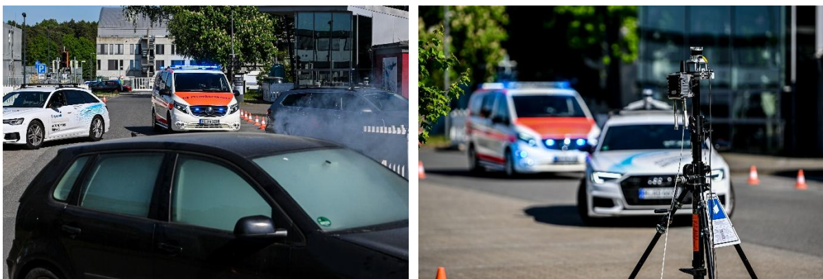
Abbildung 7: Demonstration der Rettungsgassenbildung auf dem Abschlussevent. Links: Bildung der Rettungsgasse durch Versuchsträger von DLR und Capgemini, Rechts: Steve-Mast als Infrastruktureinheit. Zur Verfügung gestellt vom © DLR.
