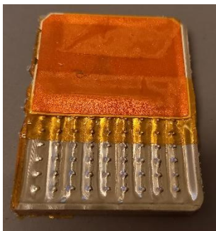
Abbildung 3: Versuchsergebnis mit hydrostatischer Druckbeaufschlagung
