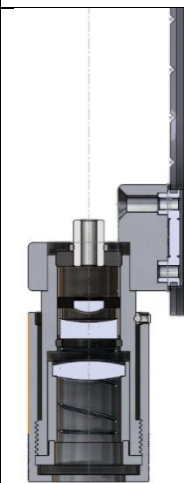
Abbildung 12: Schnittansicht durch Zoomoptik auf Schlitten
