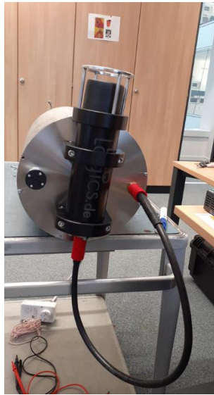
Abbildung 28: Akustisches Modem befestigt an dem Flansch des Druckkörpers.
