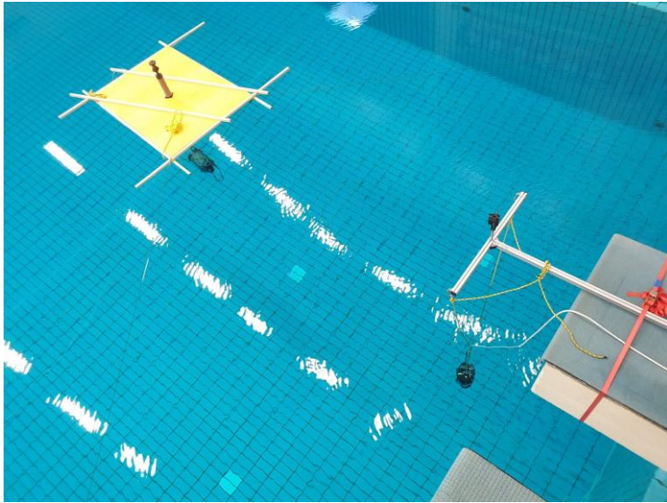
Abbildung 29: Bild des Wassertests in der Ulla-Klinger-Halle 2022 - Vogelperspektive: Trägersystem mit GNC-Sensorik stellvertretend für das nanoAUV (links) und das Referenz-USBL-Modem stellvertretend als Schmelzsonde (rechts).
