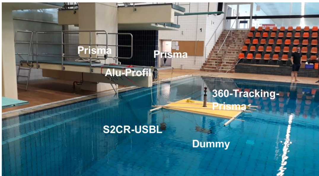
Abbildung 12 Test mit Navigations-Dummy und Floß mit Tracking-Prisma in der Aachener Westhalle.
