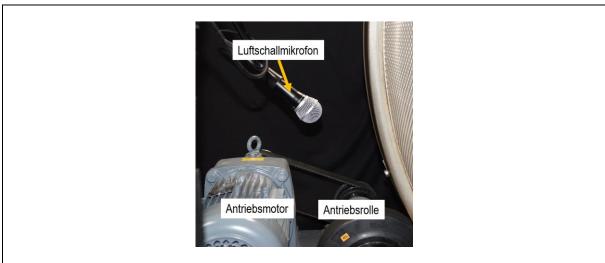
Abbildung 12: Position des Luftschallmikrofons LM1 am Versuchsstand zur Erfassung der Störsignale am Trommelantrieb (Motor und Antriebsrolle)
