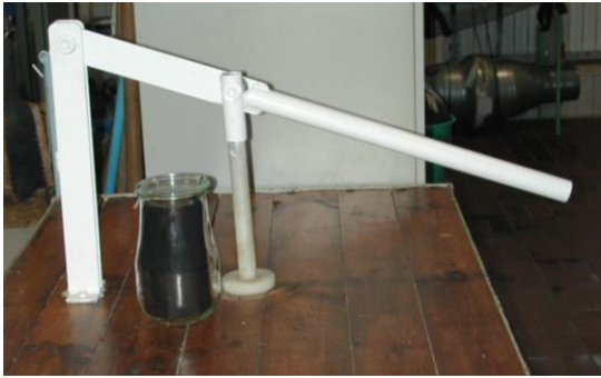
Abb. II.1.3-1: Modellsilo und manuelle Verdichtungsrichtung
