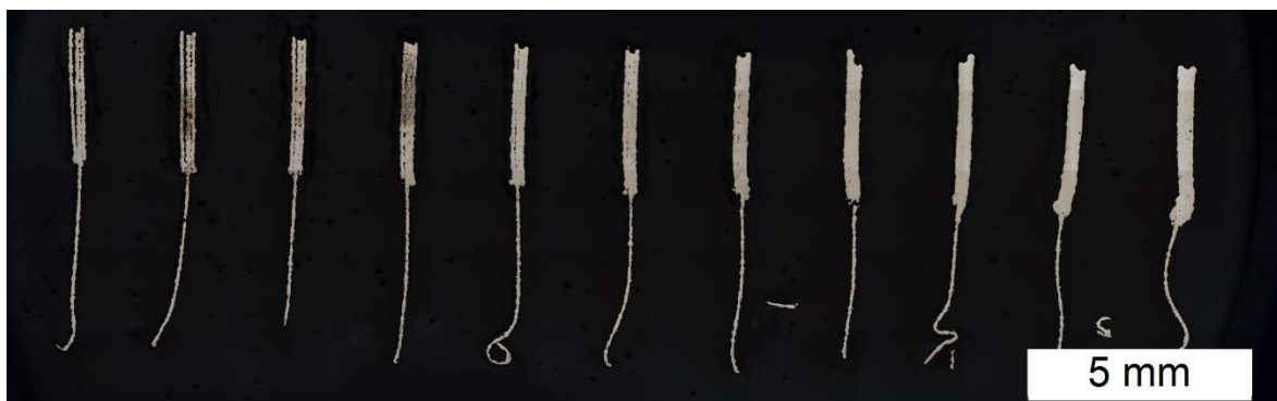
Abbildung 5: Schliffbild einer gefertigten Prüfgeometrie mit folgenden Parametern: 100 W Leistung, 0,04 mm Schichtstärke, 0,10mm Hatchabstand und variierender Belichtungsgeschwindigkeit (von links nach rechts abfallend: 1300-300 mm/s).
