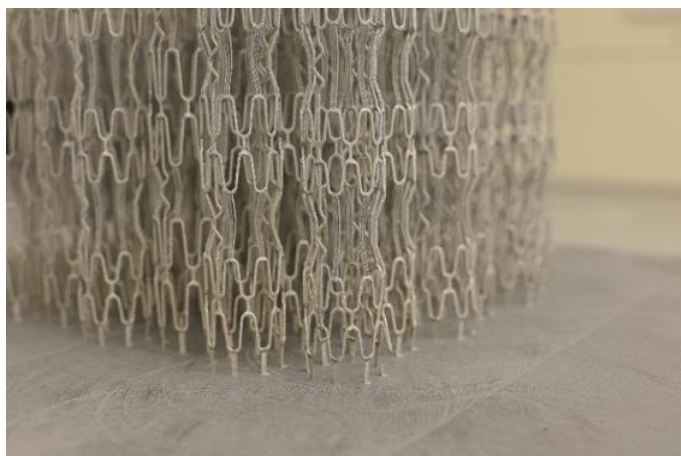
Abbildung 15: Gefertigte, gerade Supportgeometrie an Stendemonstrator.
