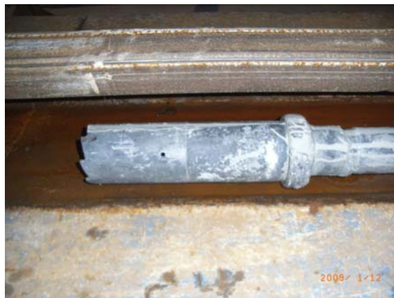
Abb. 3.5: Ausbau des gefangenen „Fisches“ (oberer Teil) des Packers
