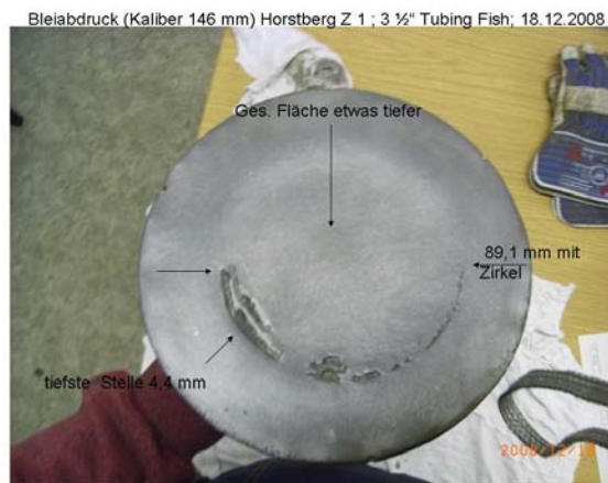
Abb. 3.4: Bleibaddruck vom Rohrstück oberhalb des Packers
