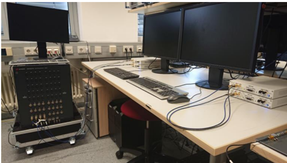
Abbildung 21: OpenAirInterface Setup 5G New Radio mit gNB und UE
