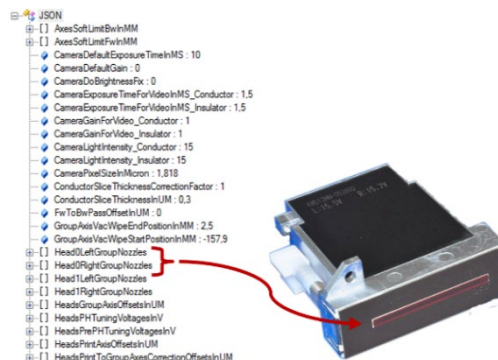
Abbildung 21: Beispiel für die Konfigurationsdaten des Druckers u.a. für die Aktivierung bzw. den Status der einzelnen Düsen der Druckköpfe
