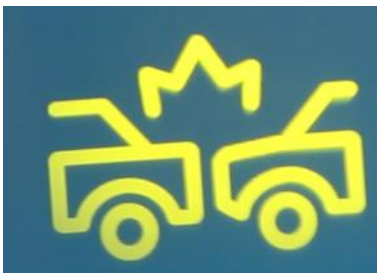
Abbildung 17: Anzeige des HUD bei Empfang der DENM mit Cause Code "Collision Risk".
