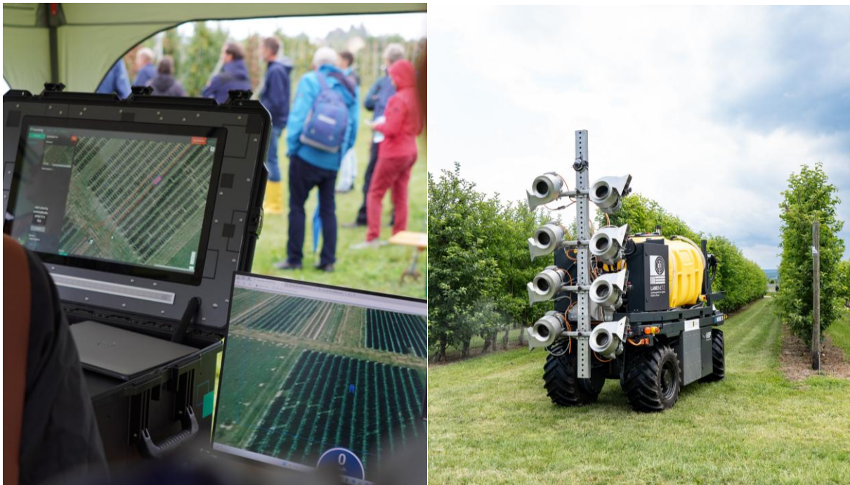
Abbildung 4: links: mobiler helyOS Leitstand, rechts: Elwobot bei voll-automatischer Missionsausführung Pflanzenschutz
