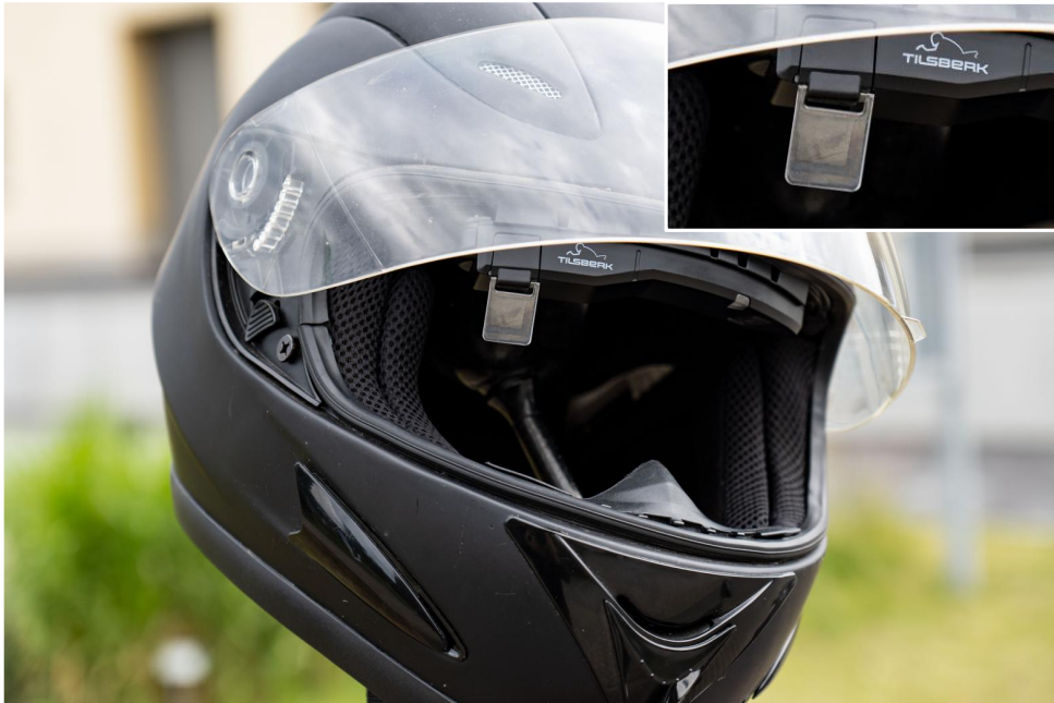
Abbildung 16: Tilsberk HUD im Motorradhelm und in Nahaufnahme (oben rechts).
