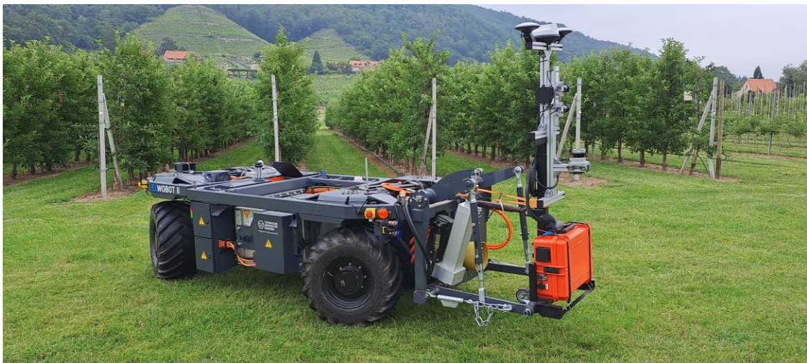
Abbildung 8 Elwobot II mit SAMSON Daten-Erfassungs-System in der Plantage Pillnitz
