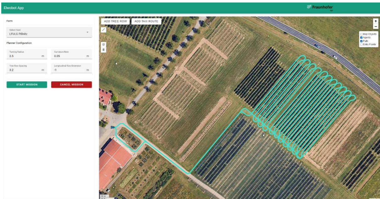
Abbildung 5: Visualisierung eines geplanten Pfades für die Ausführung einer Mission zwischen den Baumreihen der Obstplantage in der helyOS-Web-App
