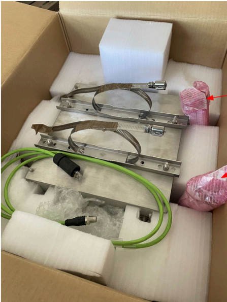
[Abb. 3: WaveBee-RSU samt Halterung, bereit für den Aufbau.]
