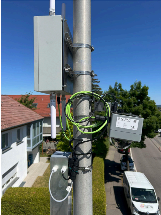
[Abb. 5: SONAH-Sensor samt WaveBee-RSU nach erfolgreichem Aufbau in Bad Wimpfen.]
