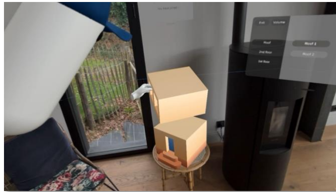
Abbildung 46: Auf er kannten horizontalen Flächen können die Bausteine platziert/ gestapelt werden.
