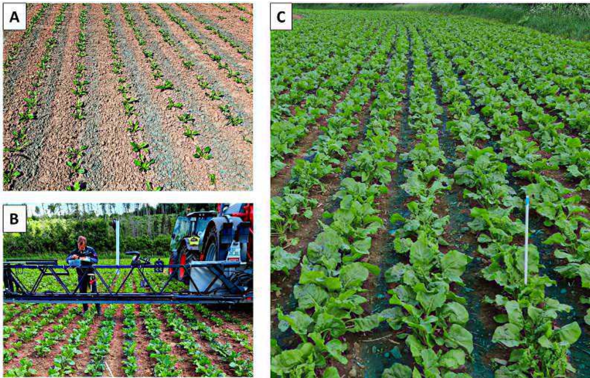
Abbildung 1 Funktionstests der Streifenspritzung mit einer Horsch-Spritze (HL6GS) mit Farbtracer-Ausbringung auf einer Versuchsfläche in Weende (A) und auf einem Praxisbetrieb in Adelebsen (B, C) im Mai 2022
