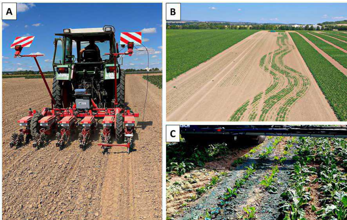
Abbildung 2 Aussaat mit RTK-GPS-Tracker (A), für Funktionstests der HL6GS vorbereiteter Schlag mit geradem und kurvigem Reihenverlauf (B) und Durchführung von Funktionstests (C) auf der IfZ-Versuchsfläche Sieboldshausen 2022
