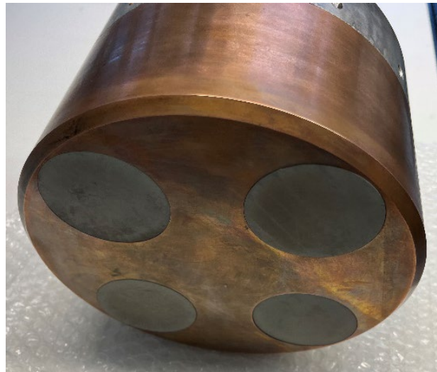
Abbildung 16: Schmelzkopf mit integrierten Antennen
