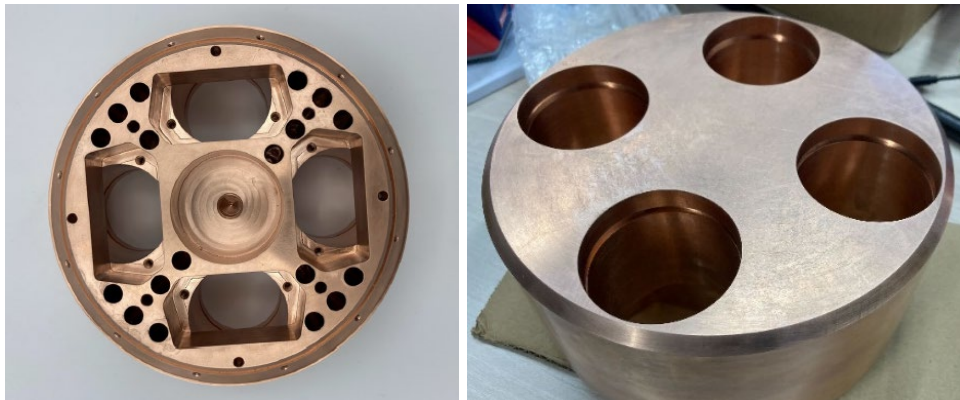
Abbildung 7: Rückseite und Vorderseite des CNC-bearbeiteten Schmelzkopfs vor der Integration der Antennen
