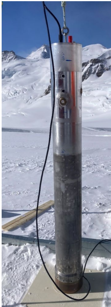
Abbildung 36: FRS-Schmelzsondendemonstrator vor dem Einschmelzvorgang auf dem Aletschgletscher 2023
