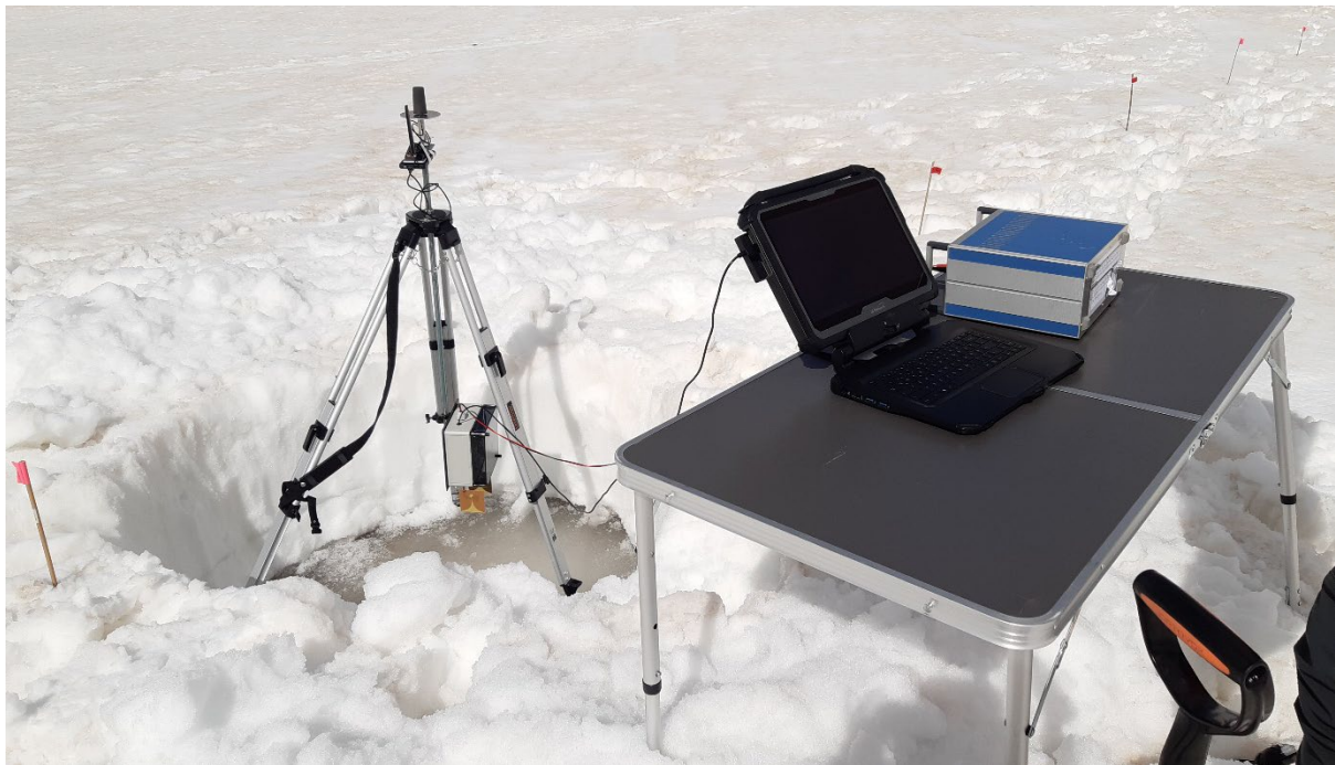
Abbildung 31: Messaufbau des Radarsystems montiert auf einem Dreibein
