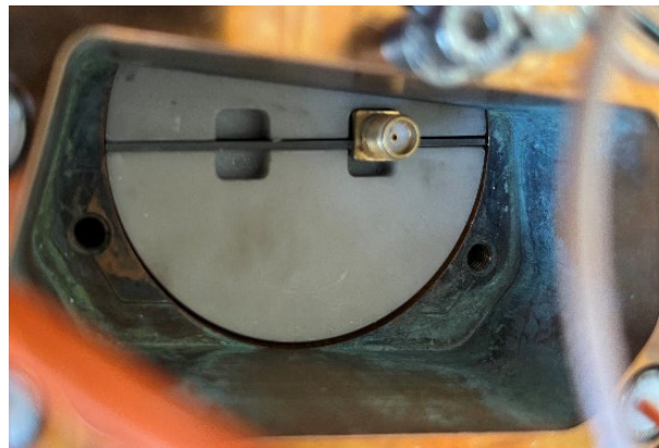
Abbildung 17: Rückseite einer der in den Schmelzkopf integrierten Antennen
