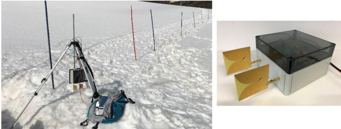
Abbildung 25: Messaufbau des Prototyp-Sequential-Sampling Impulsradars mit Vivaldi Antennen
