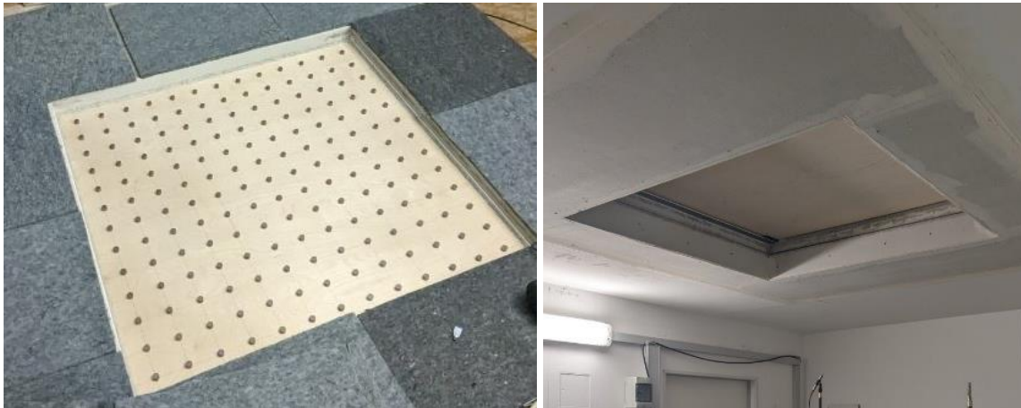
Abbildung 6. Versuchsaufbau zur Messung der akustischen Eigenschaften einer Platte mit VAMM bei Luftschallanregung.
