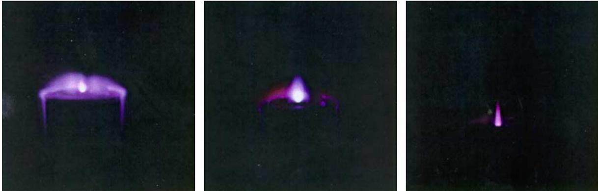
*Abb. 9 Optimierung des reaktiven Plasmastrahles durch Änderung der Quellengeometrie einschließlich HF-Abschirmung und der Prozeßparameter*
