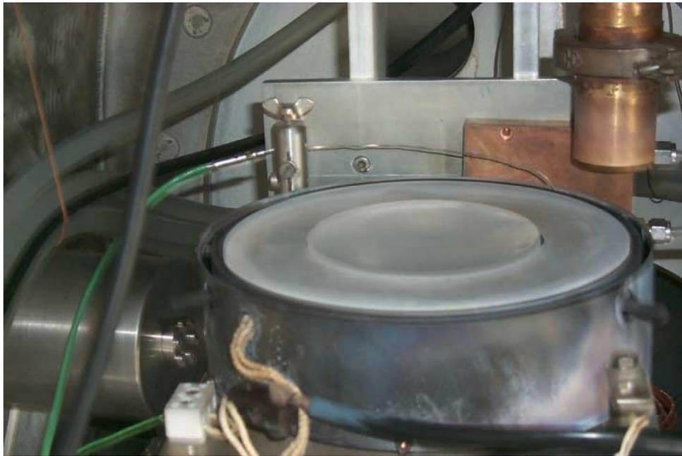
Abb. 8 Einbau der Probenheizung in die Versuchsanlage.
