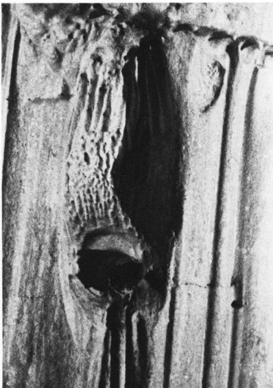
Bild 6. Verschleiß im Elektrodenbereich.
